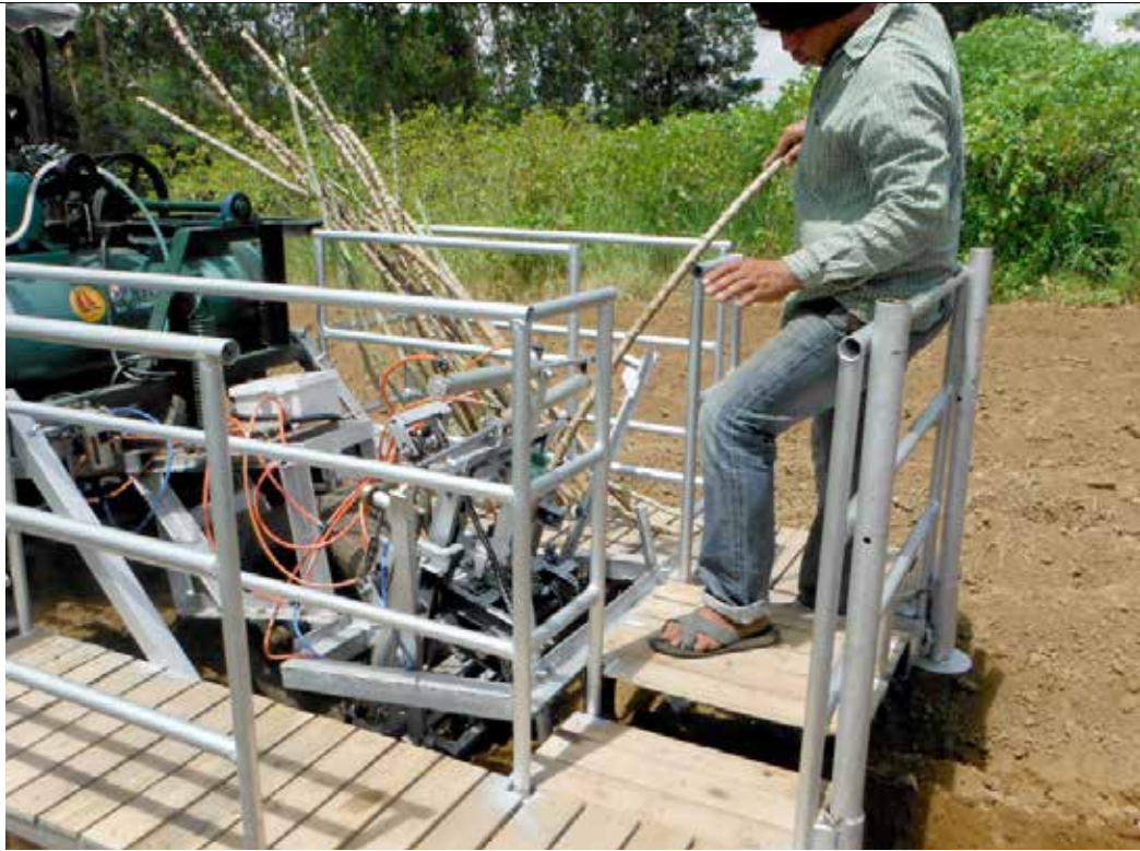
▲ เครื่องปลูกมันสำปะหลังแบบนิวเมติกใช้แรงงานคนเพียง 2 คน ปลูกได้ถึง 0.5 ไร่/ชม.
