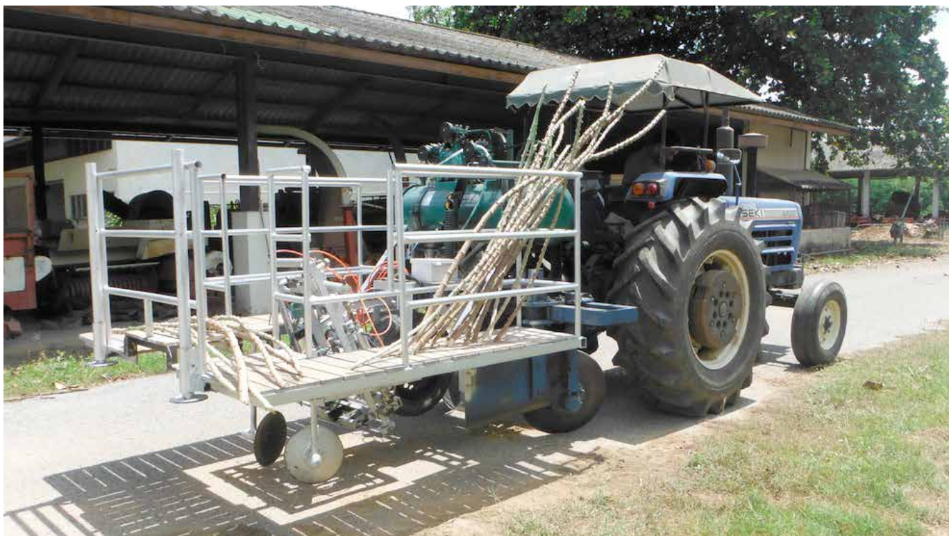
▲ เครื่องปลูกมันสำปะหลังแบบนิวเมติก
