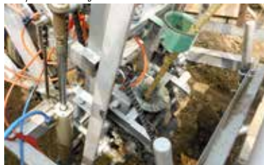
▲ ชุดป้อนต้นมันสำปะหลัง เป็นชนิดลูกกลิ้งยาง
