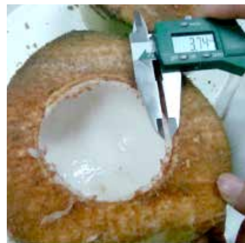
▼ วิเคราะห์คุณภาพทางกายภาพด้วยการวัดจำนวนชั้นของเนื้อมะพร้าว, ความหนาของเนื้อโดยเครื่องเวอร์เนียดิจิตอล
