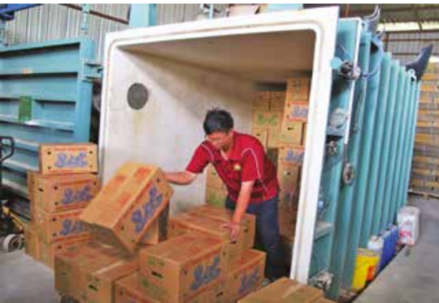
▲ ห้อง Vacuum Cooling ใช้สำหรับลดอุณหภูมิอย่างเฉียบพลัน 2-3 องศาเซลเซียสภายใน 20 นาที เป็นกระบวนการเก็บรักษาหลังการเก็บเกี่ยวที่ช่วยให้ผักเก็บได้นานขึ้นประมาณ 2 สัปดาห์
