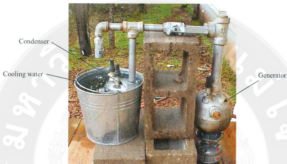
รูปที่ 4 แสดงเครื่องทำความเย็นแบบดูดกลืนอย่างง่าย (แบบเก่า) โปรดเปรียบเทียบกับรูปที่ 4 กับรูปที่ 5
