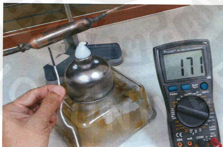
รูปที่ 18 แสดงการให้ความร้อนแก่ generator ด้วยตะเกียงแอลกอฮอล์ สามารถทำอุณหภูมิได้สูงถึง 171^{\circ}\text{C}
