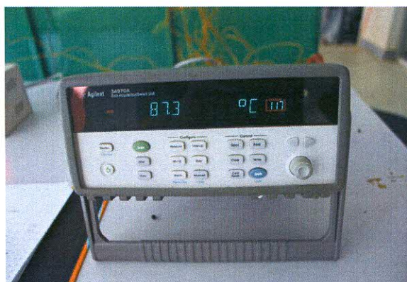
ภาพผนวก 7 ชุดอุปกรณ์เก็บข้อมูลอุณหภูมิ ยี่ห้อ Agilent technology รุ่น 34970A
