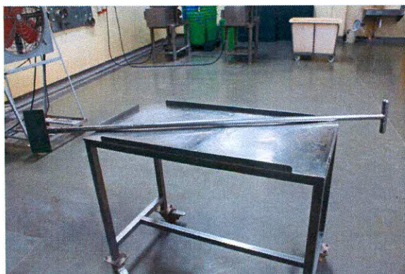
ภาพผนวก 5 อุปกรณ์สำหรับพลิกกลับพริกไทยในการทดลอง ทำด้วยสแตนเลส
