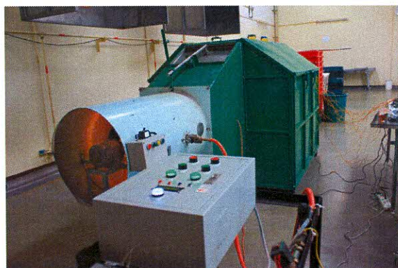
ภาพผนวก 5 อุปกรณ์สำหรับพลิกกลับพริกไทยในการทดลอง ทำด้วยสแตนเลส
