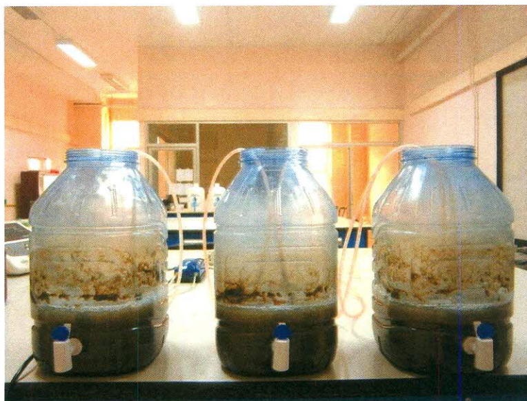
ภาพ 16 การทดสอบกลุ่มแบคทีเรียที่เหมาะสมในถังปฏิกรณ์ระดับห้องปฏิบัติการ
