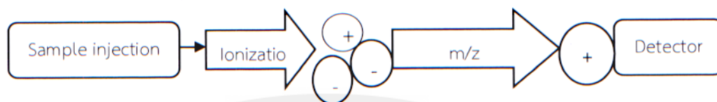
ภาพที่ 20 หลักการทำงานของเครื่องแมสสเปกโตรมิเตอร์
